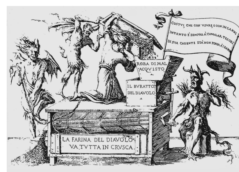
6. Raffigurazione di un buratto a tombolo in una stampa di Giuseppe Maria Mitelli (Bologna 1688). La macchina, disponibile a Bologna già negli anni Trenta del secolo XVII, è l'esito del perfezionamento del frullone e sfrutta forme e materiali ancora oggi in uso nei mulini industriali.
